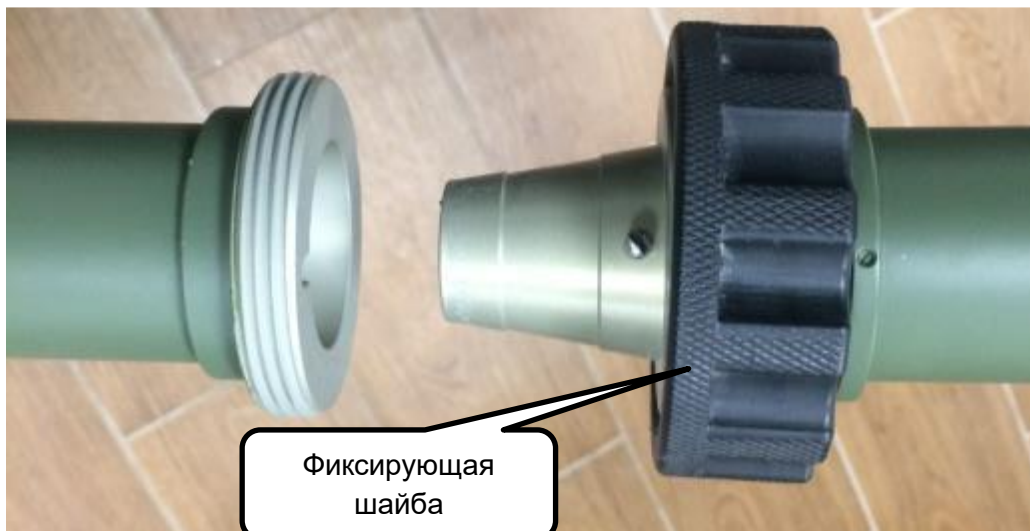
Рисунок 2.3.1.10.2 Сборка держателя облучателя
